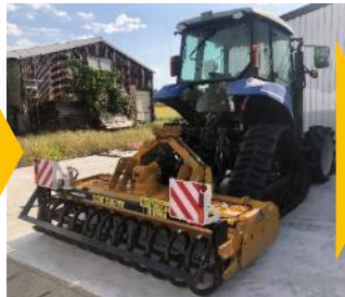
② バーチカルハローで 砕土・整地・鎮圧
