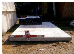
(7) PC板設置工事に係る写真 寸法の検測状況写真 設置後の水平が確認できる写真
