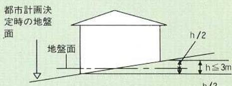
建築物が地面に接する位置の高低差が3m以下のとき。
