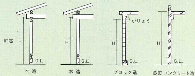
[注]図に示す「軒の高さ」は、G.L.から軒げた・はな母屋の上端までの垂直距離である。したがって「法にいう軒の高さ」とは異なります。
