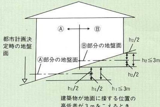
建築物が地面に接する位置の高低差が3mを超えるとき。
