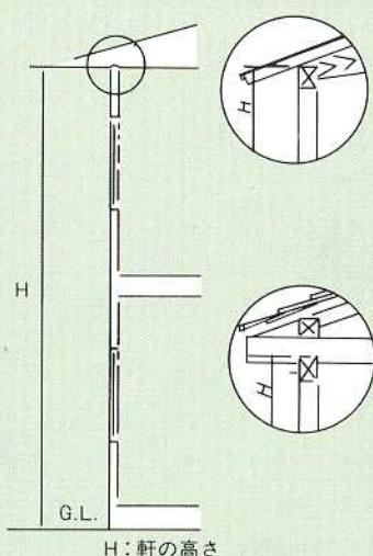
地盤面から建築物の小屋組、これに代わる横架材（はり・がりょう・けたなど）を支持する壁、敷げた、または柱の上端までの垂直距離をいいます。
