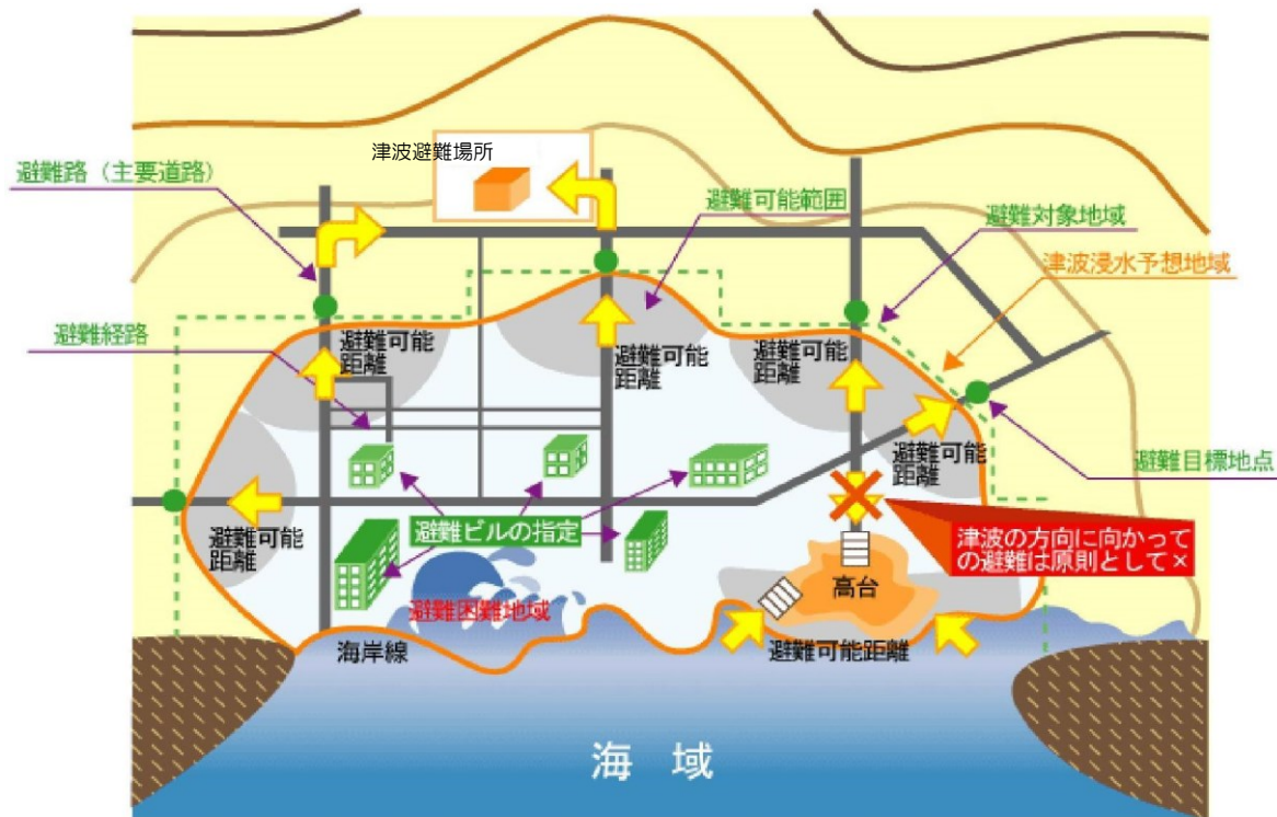
※避難困難地域設定の概念図（出典：市町村における津波避難計画策定指針）
